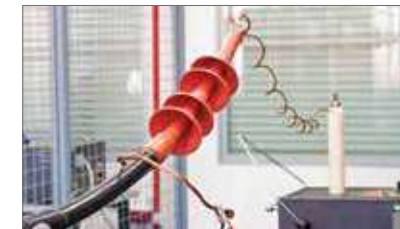
Высоковольтные испытания кабельных муфт
